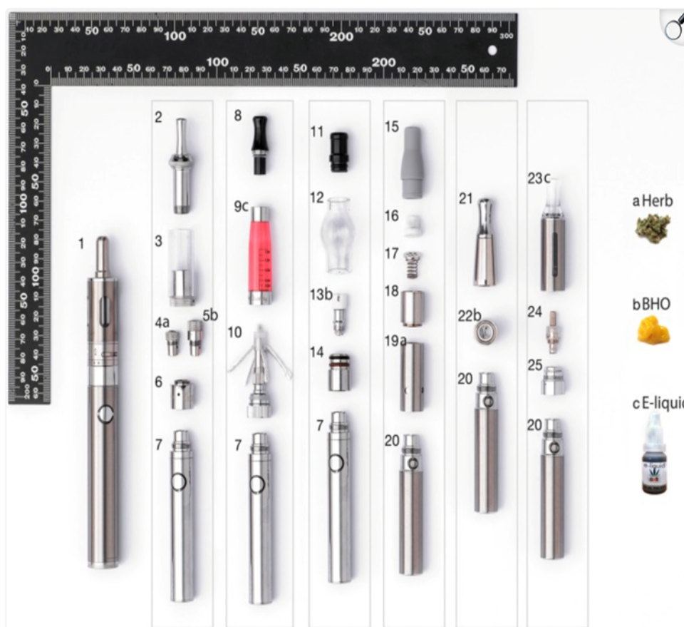
Figure 2. Différents composants d'un dispositif de vapotage impliquées dans l'usage du cannabis
